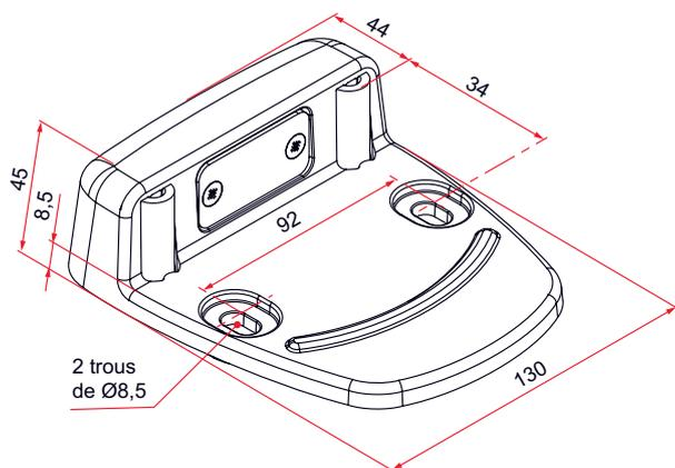
– Semelle en aluminium hauteur 45 mm, à visser ou à sceller (avec pattes de scellement non fournies)
