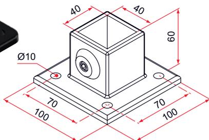
– Permet de fixer, par vissage au sol, les arrêts avec tube de 40x40 mm
