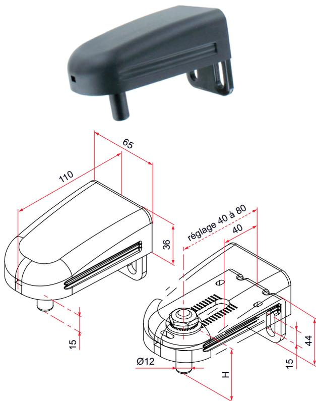
■ Gond platine en L avec carénage aluminium - H.57 - réglage 40 à 80 - pivot Ø12, H.25 ou 35
