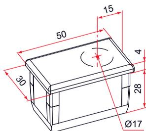
– Pour bague en laiton ou en composite
