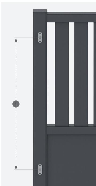
1 L'entraxe, l'usinage et l'intégration des inserts prennent en compte le pourcentage de la pente relevé par le métreur. Ce relevé correspond à un entraxe indiqué dans la notice de montage.
