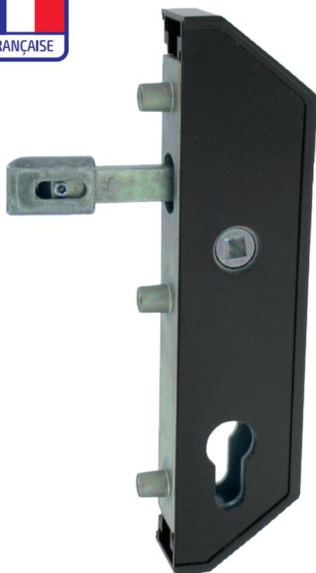
Conçue pour se monter en retrait sur tout type de cadre métallique ou en bois, cette serrure est réversible à la fois sur le sens du montage (droite ou gauche) et sur le sens d'ouverture (intérieur ou extérieur).
