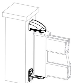
Ce système d'ouverture réglable, permet des ouvertures standards pour tous les types de portails. Protection du pivot avec un manchon composite pour limiter la corrosion et améliorer l'antifriction lors de la rotation.
