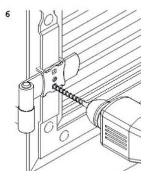
6 Percer l'ensemble (noeud penture volet et contre-penture) en utilisant les deux orifices carrés comme canons de guidage.
