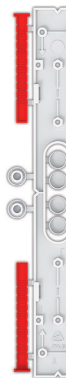
2 Les 2 languettes permettent de positionner les différents éléments sur le support sans prise de cotes.
